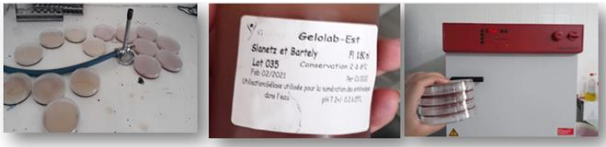
Figure 19 : Processus de filtration et dénombrement des streptocoques.
