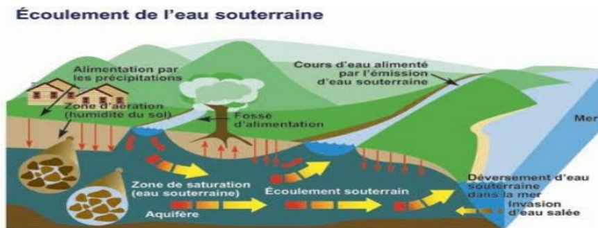
Figure 01: Représentation de l'écoulement des eaux souterraines
