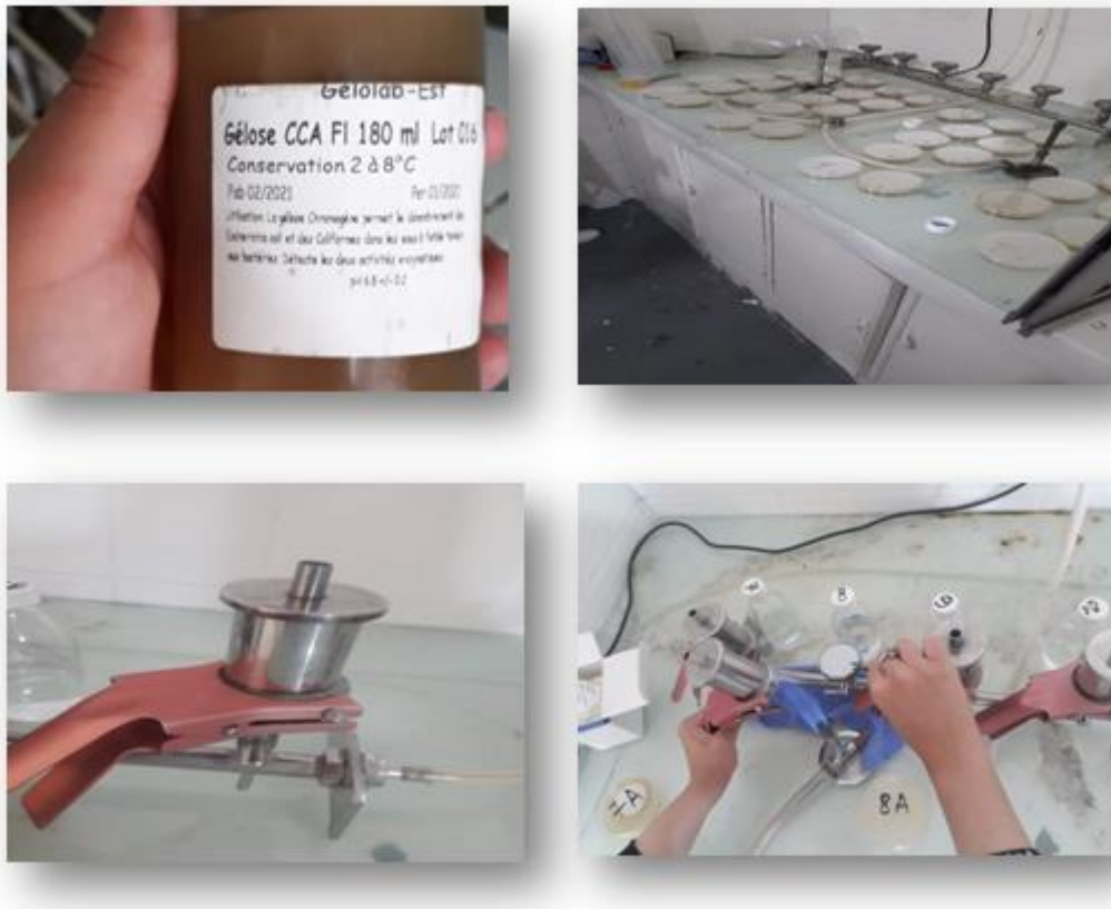
Figure 18 : Processus de filtration et dénombrement des coliformes totaux et fécaux.
